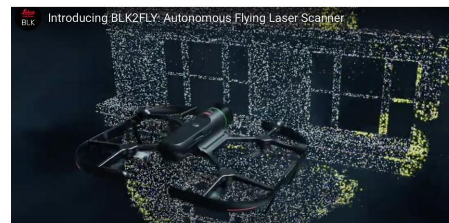
Figura 98- Leica BLK2FLY e a transmissão simultânea da nuvem de pontos. Fonte: www.leica-geosystems.com .
