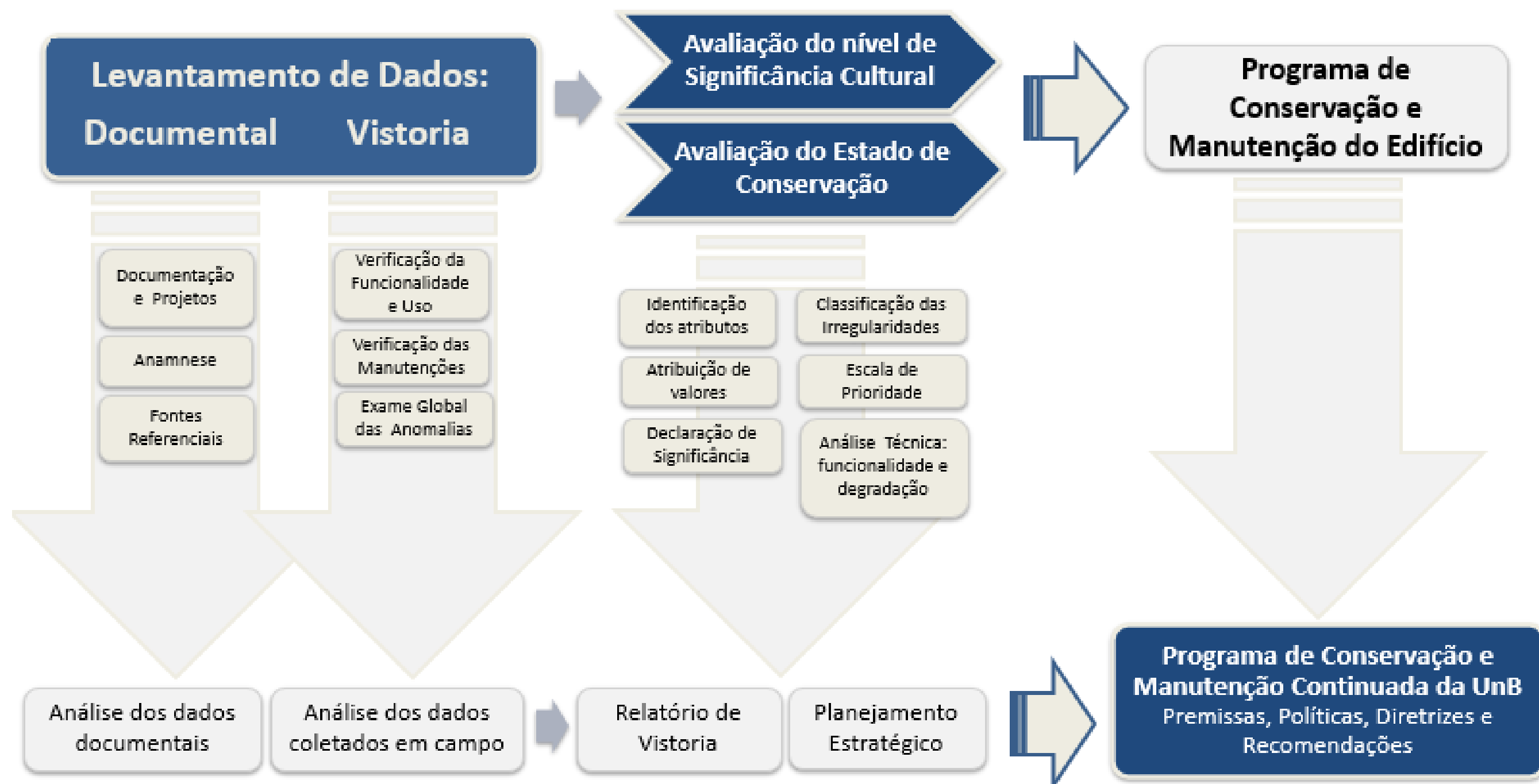
Fluxograma 7 – Concepção e delineamento das etapas do processo integrado para a elaboração do Programa de Conservação e Manutenção Continuada da UnB. Fonte: Os autores.
