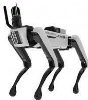
Figura 99 - O Leica BLK ARC de escaneamento autônomo. Fonte: www.leica-geosystems.com
